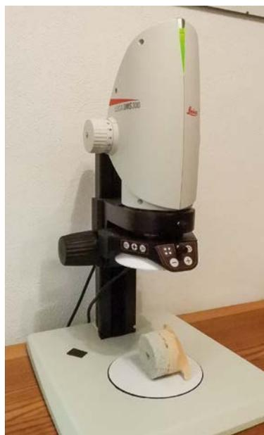
Abb. 1: Einfaches Auflichtmikroskop mit großem vertikalen und horizontalen Verstellbereich zur Betrachtung großer Proben, wie es in der Baustoffanalytik eingesetzt wird.
